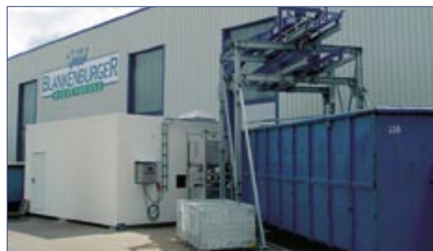
Behältertransport - die Transportsysteme sind übersichtlich, gemäß den Forderungen des Hygienic Design konstruiert.
