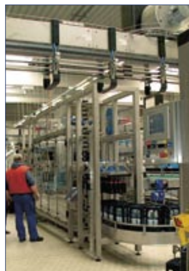
Behältertransport - die Transportsysteme sind übersichtlich, gemäß den Forderungen des Hygienic Design konstruiert.
