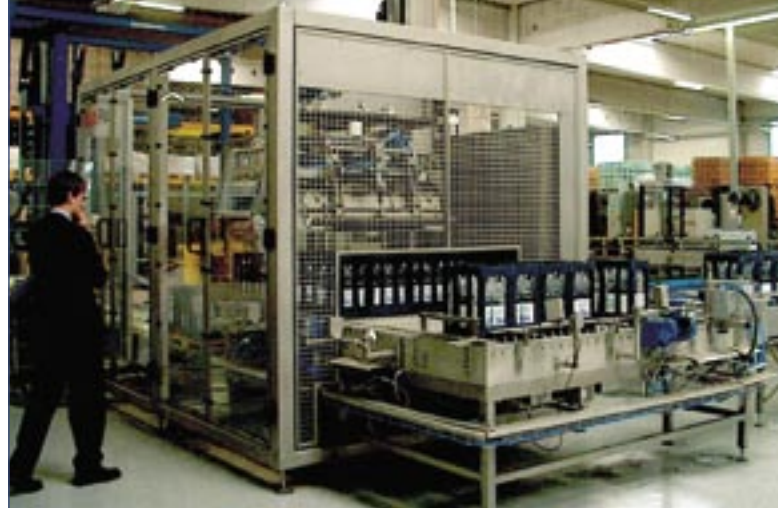
MultiPal mit Gruppierstation - die Palettiermaschine wird als Be- und Entlader eingesetzt
