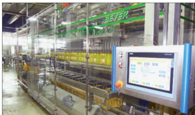
Der Einpacker „MultiPac II“ füllt bei jedem Hub neun Kisten, bis zu 80000 Flaschen in der Stunde. (Fotos: Beyer Maschinenbau)
