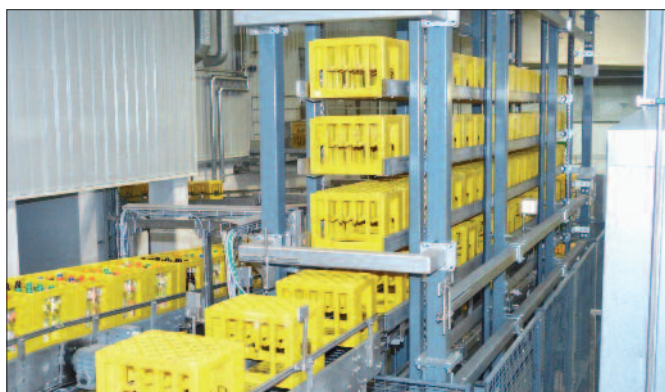
Ausgepackte Kisten werden optisch kontrolliert und direkt zum Kistenwascher und weiter zum Einpacker transportiert oder zuvor im neuen Kistenmagazin zwischengepuffert.
