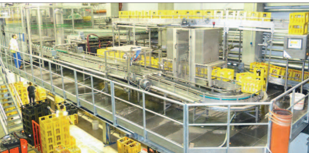
Die neue Auspackmaschine „MultiPac II“ samt Entkorker steht nun im Obergeschoss. Die manuelle Sortierung bei zu vielen Fremdflaschen ist im Erdgeschoss.
