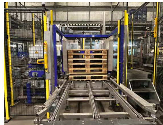
Pufferplatz für Paletten zwischen Entpalettierungs- und Palettierungslinie.
