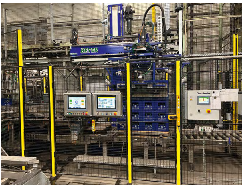
Direkt an den bestehenden Kastentransport angebunden: die kompakte Palettierstation für Vollgut-Kästen.
