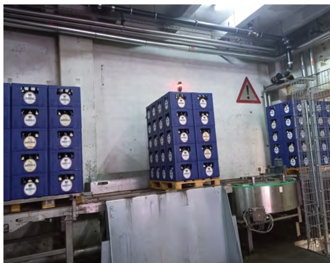
Ab hier geht's ins Lager: Die Abgabe der Doppelpaletten an den Stapler – mit erweitertem Pufferplatz.
