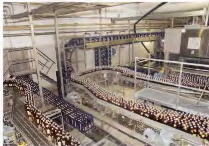
Durch lange Staustrecken beim Flaschentransport ist die Linie wesentlich flexibler
