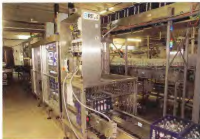
Vor dem Auspacken werden die Flaschen im Entkorker von ihren Verschlüssen befreit
