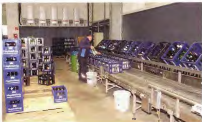
Kisten mit falschen Flaschen oder Fremdkörpern werden ausgeschleust und manuell bereinigt
