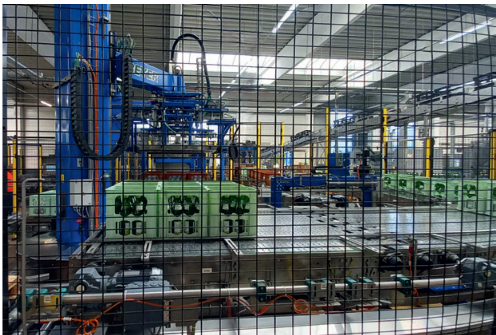
Auf zwei Gruppiertischen werden die nicht verarbeitete Kistensorte als Leergut und das Vollgut parallel verarbeitet.
