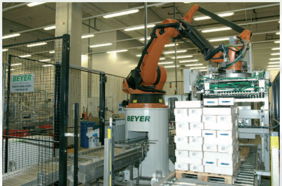
Der Einarm-Roboter kann sich in bis zu 4 Achsen bewegen und Traglasten bis zu 110 kg exakt aufnehmen und absetzen
