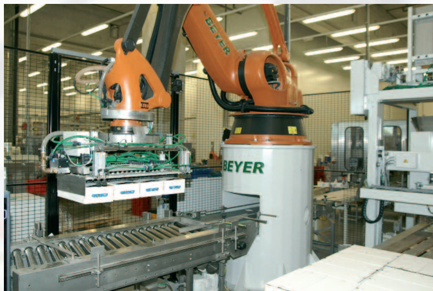
Die zehnte Linie wurde jetzt mit einem Palettier-Roboter von Beyer bestückt. Ein Verpacken per Hand war hier auf Grund der großen Menge nicht mehr möglich
