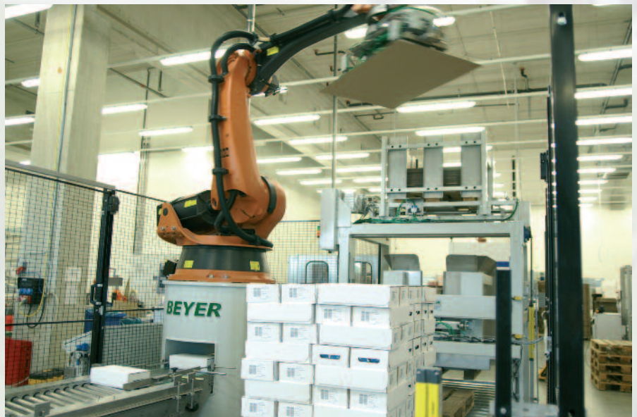
Direkt an den Einarm-Knickroboter hat Beyer ein Paletten- und ein Zwischenlagenmagazin sowie eine Gebinde- und Palettenfördertechnik aus Edelstahl angebaut
