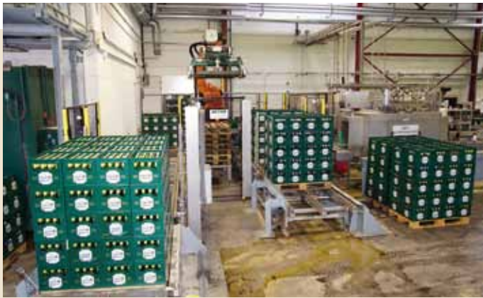
Nach dem Aufsetzen von zwei Leergutpaletten (re.) fahren diese auf Kettenförderern in die Maschine ein
