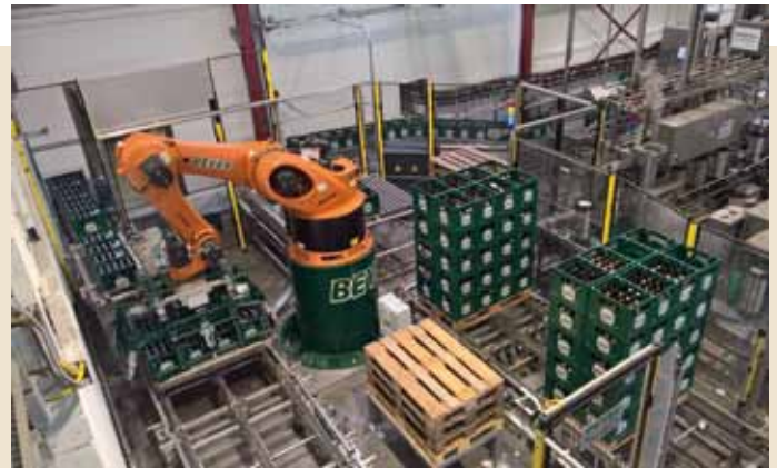
Der Roboter übernimmt außer dem Handling von 1384 Voll- und Leergut auch die leeren Paletten
