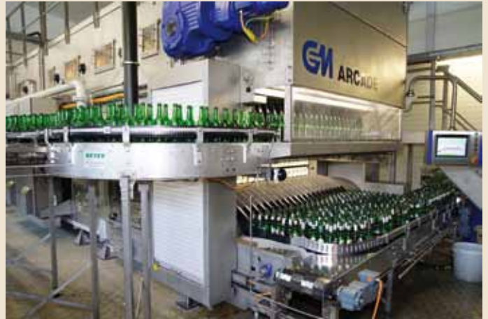
Bis zu 18000 Flaschen in der Stunde können in der neuen Waschmaschine gereinigt werden
