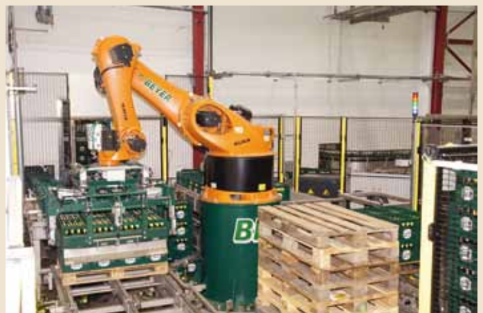
Der 5-Achs-Roboter mit 470 kg Traglast ist eine kombinierte Palettieranlage für lagenweises Be- und Entladen
