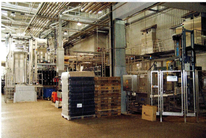
Die neuen Beyer-Maschinen in der Ustersbacher Ladehalle: Neuglasabschieber sowie je ein Be- und Entlader „MultiPal“
