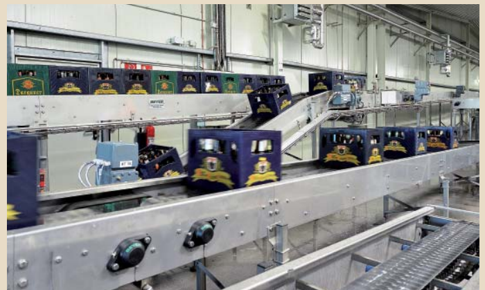
Abb. 2 Die zu sortierenden Kisten werden mittels Weiche auf einer Bahn zusammengeführt
