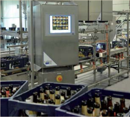
Abb. 3 Die Kastenkontrolle garantiert eine Erkennungsgenauigkeit von über 99,7%
