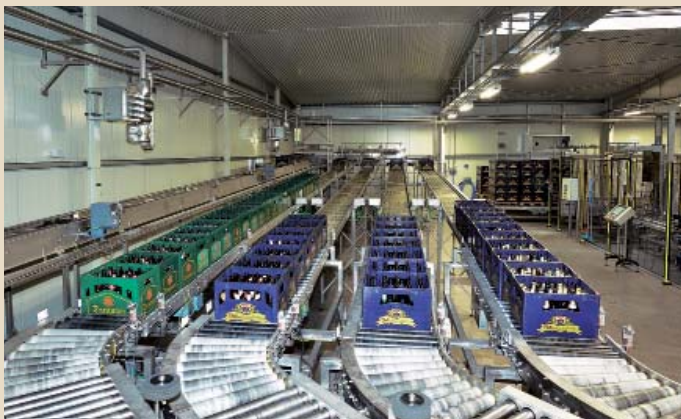
Abb. 1 Edelstahl-Transportanlage mit vier Bahnen
