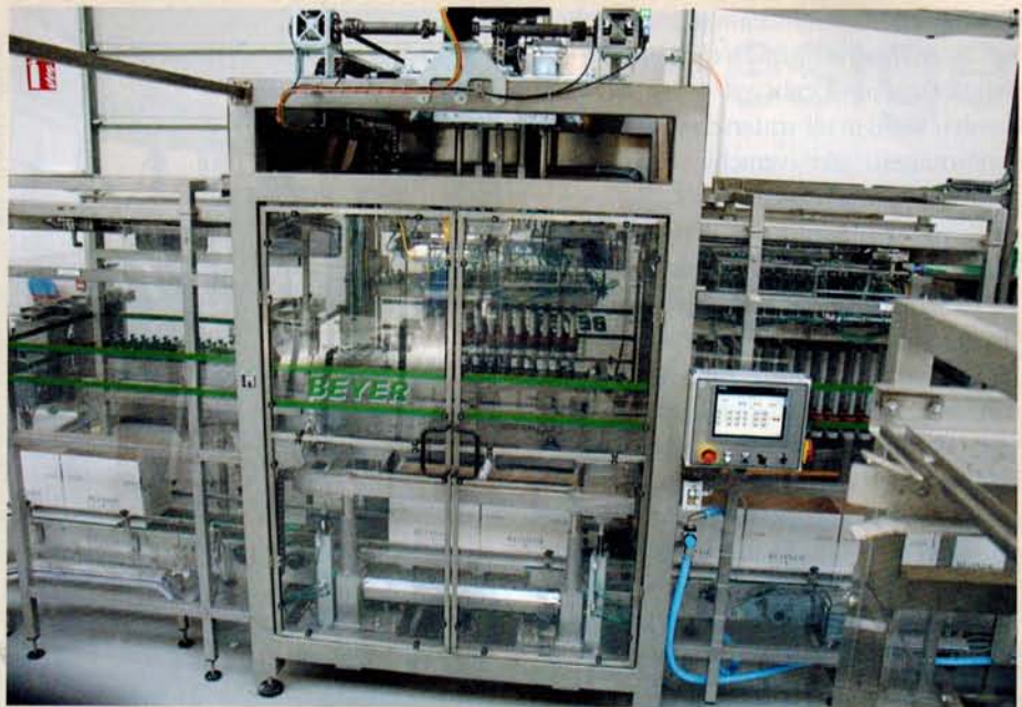
Abb. 3 Der neue Flascheneinpacker speziell für den Mittelstand verfügt über drei Packkopf- magazine
