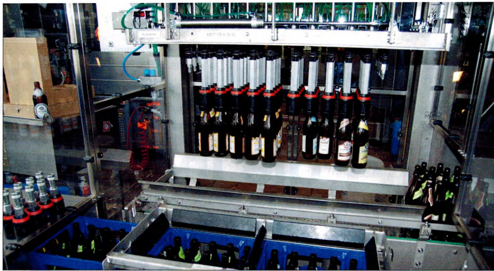
Auf engstem Raum wurde auch die Auspackmaschine von Beyer in Reichelshofen installiert. Gebaut aus NIRO, angetrieben über Zahnriemen, geführt von einem Laufwerk aus wartungsfreien Vulkollanrollen.
