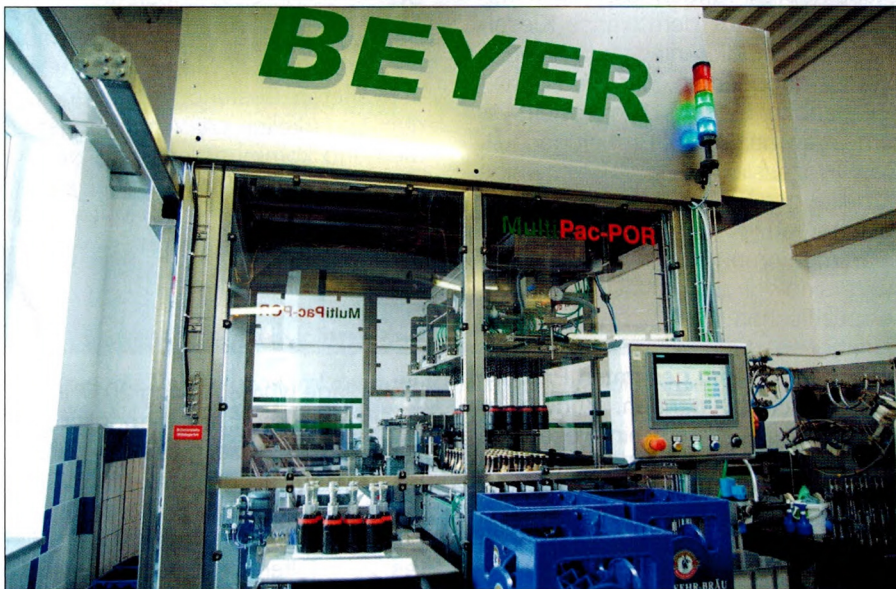
Bei der Landwehrbräu verzichtete man aus Platzgründen auf Wechsellpackköpfe in einem Magazin, beim Kisten-Wechsel werden die zusätzlichen Packtulpen (vorne links) auf Leerdorne gesteckt.
