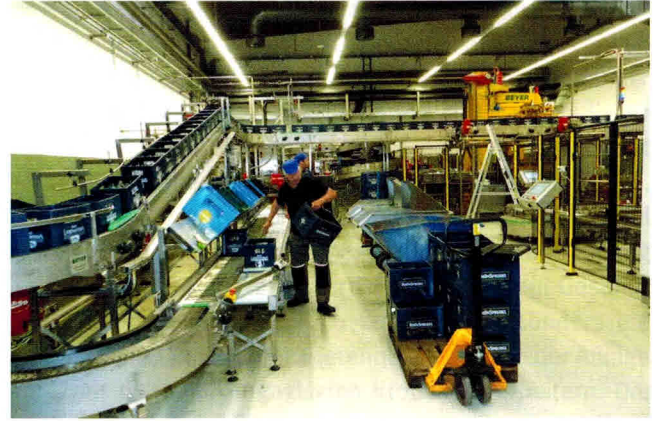
„Korrekte“ Kästen mit Fremdflaschen werden manuell sortenrein gemacht, aktuell nicht verarbeitete Kästen werden ebenfalls sortiert, fahren dann in die Abfüllhalle zum Sortenbelader für den späteren Einsatz.
