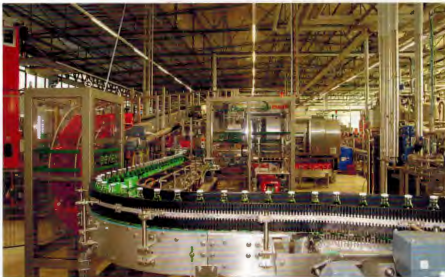
Nach dem Reinigen der Flaschen werden sie befüllt, verschlossen und etikettiert, dann geht es auf einem Transporter weiter zum Einpacken
