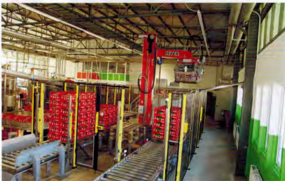
Ein Drehsäulenpalettierer be- und entlädt die Paletten, legt aber auch leere Paletten an die richtige Position
