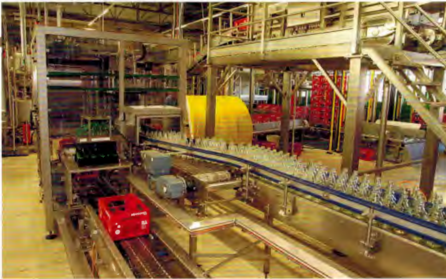
Manuell wurden aus den leeren Kisten die Fremdkörper oder falschen Flaschen entfernt, heute werden die leeren Kisten vor dem Reinigen um 180 Grad gedreht, dabei fallen viele Fremdkörper heraus
