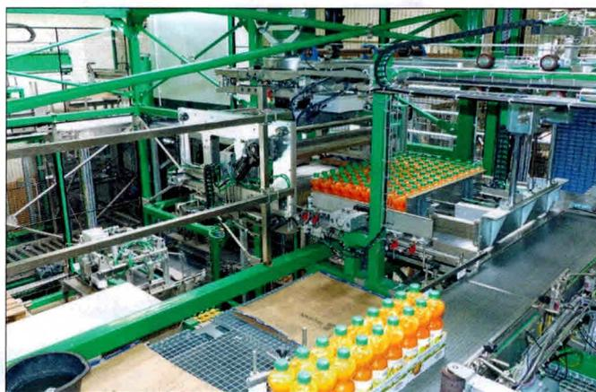
Der kombinierte Be- und Entlader vom Typ „MultiPal“ hat zwei Greiferköpfe: einen Klemmkopf für Kästen, einen Röllchen-jalousienkopf für die Palettierung von Einweg-Kartons oder Trays. Der Greiferkopfwechsel der Maschine erfolgt vollautomatisch.
