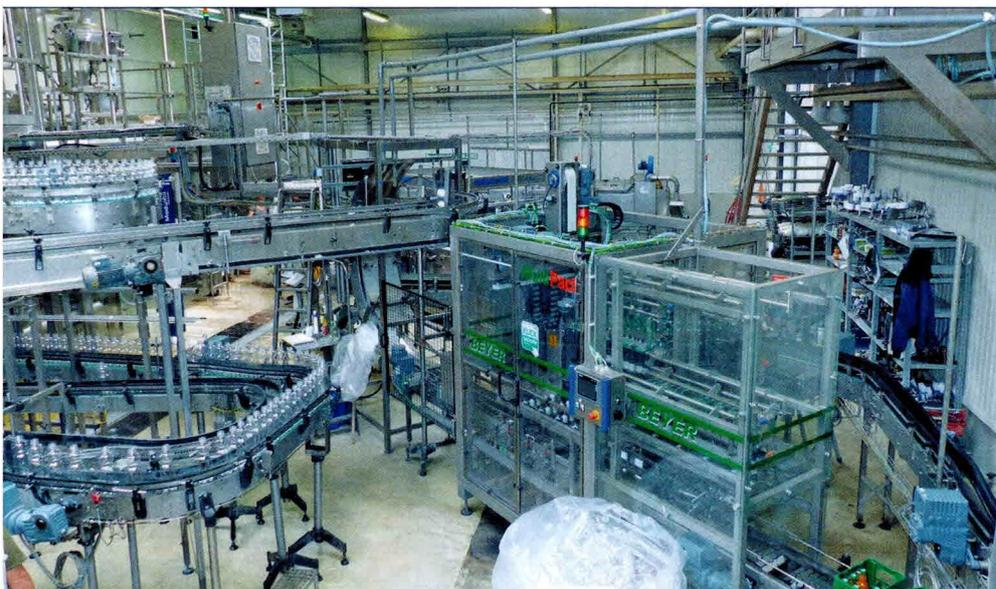
*Auf engstem Platzangebot realisierte Beyer bei Sachsenobst den Trockenteil einer kombinierten Glas-/PET-Linie für 10 Millionen Flaschen im Jahr. Sämtliche Elektrik und Elektronik sitzt in 2 Meter Höhe.*
