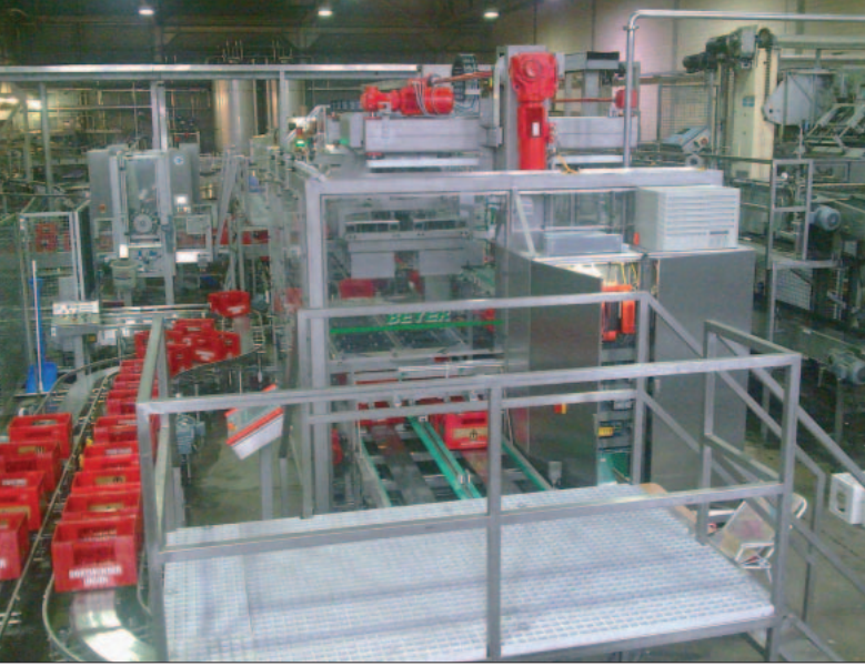
Die 0,5-l-Mehrweg-Flaschen fahren auf einer sechs-bahnigen Zuführung bis zum Flaschentisch des Einpackers, wo sie von zehn Greiferköpfen à 20 Packtulpen abgenommen werden.
