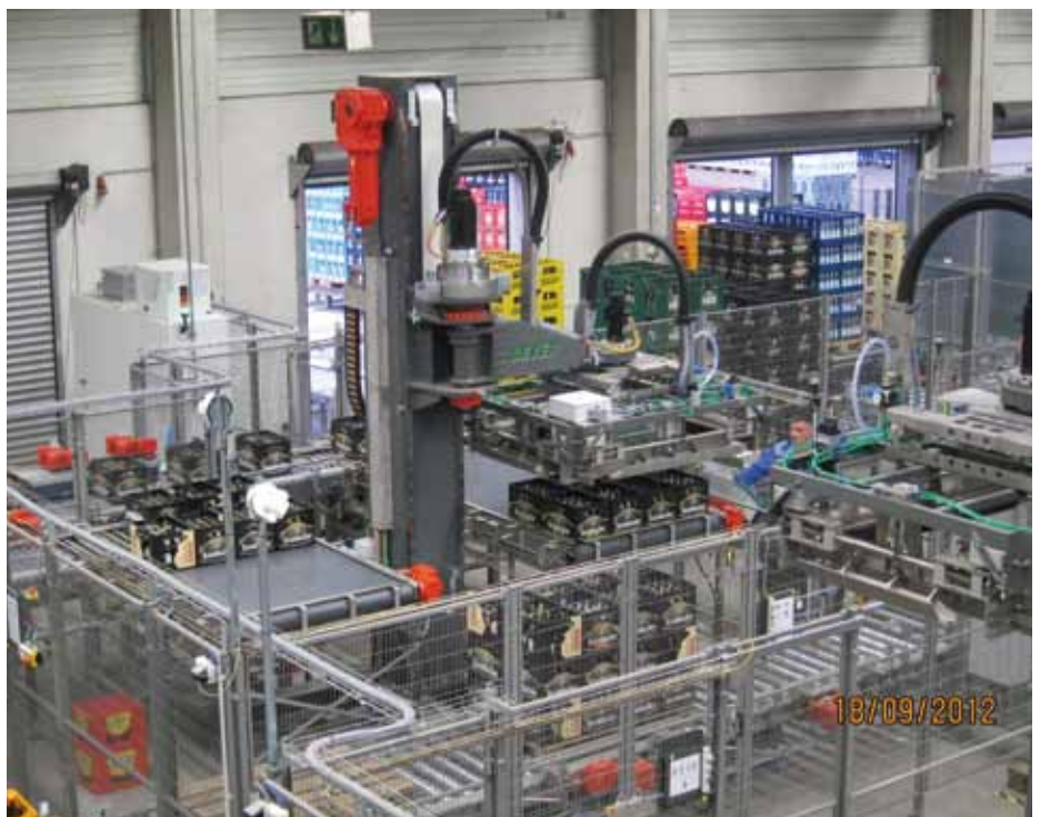
Schwenkpalettierer mit drei Achsen, aufgestellt in einer Kastensortieranlage im Getränkefachgroßhandel
