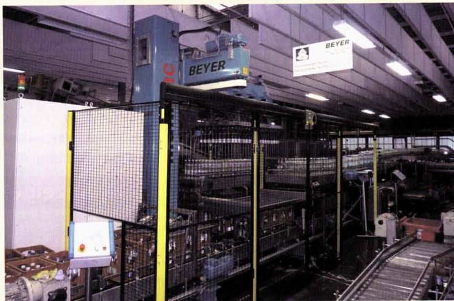
Der energiesparende Einsäulen-Flaschenauspacker holt bei jedem Hub 120 GdB-Flaschen aus den Kisten
