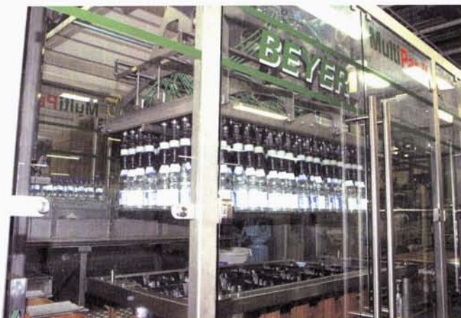
Der Zweisäulen-Einpacker kann in der Stunde bis zu 48 000 Flaschen in die Kästen setzen
