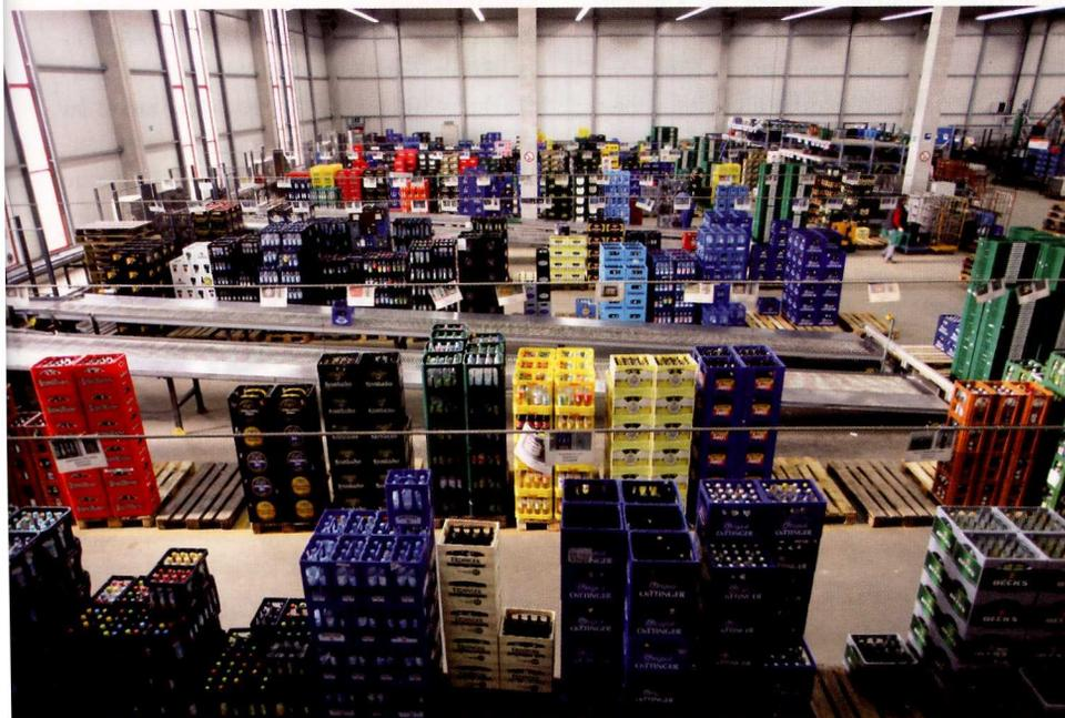
**Die fertigen, sortenrein gefüllten Getränkekästen werden an den vier Sortierbahnen ausgeschleust**
