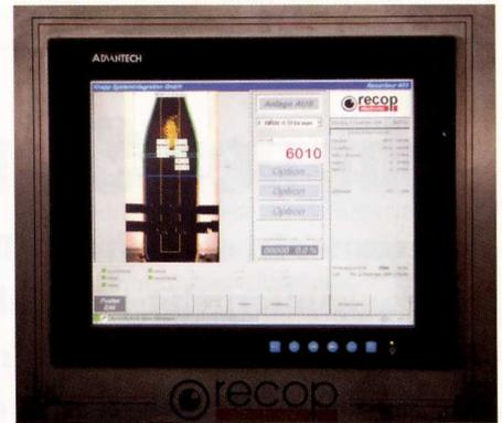
**Sämtliche Flaschen und Kästen durchlaufen die Bilderkennung, in der 150 unterschiedliche Kästen- und 100 Flaschenmuster hinterlegt sind**
